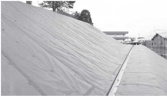
写真1 シート表面に平滑加工を施している“ニードフル防草シート 表面平滑タイプ”は、シート表面に付着した土埃や飛来種子が風で飛ばされやすくなっているため、雑草の活着を抑えることができる
